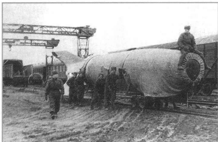
Выгрузка и транспортировка ракет Р-1 первых испытательных серий на ЖД-станции полигона Капустин Яр
